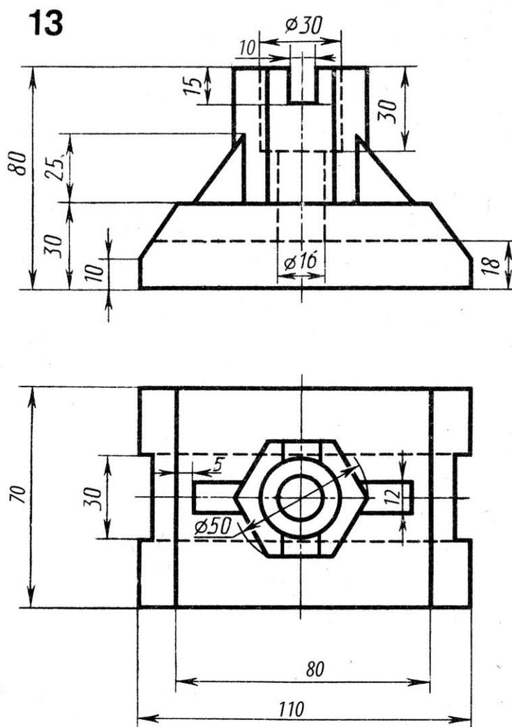
**Задание.** По двум проекциям модели построить третью. Выполнить необходимые разрезы. Нанести размеры. Построить аксонометрическую проекцию (изометрия) с вырезом передней четверти.
